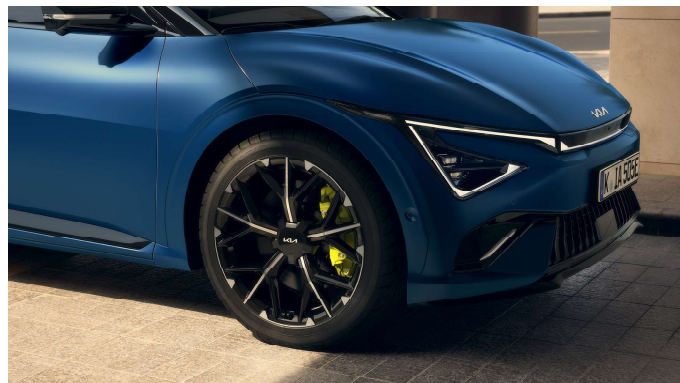
21" slitinový disk GT s pneumatikami 255/40 R21
