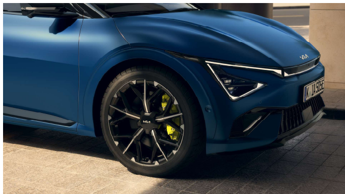
21" slitinový disk GT s pneumatikami 255/40 R21
