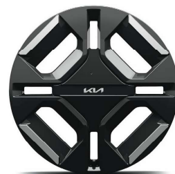
19" slitinový disk s pneumatikami 215/50 R19 - GT-Line
